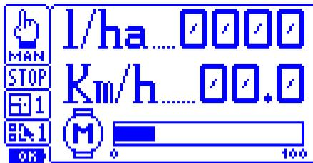
In diesem Betriebsmodus ist es auch möglich, die Digitalanzeige des Automatikbetriebs durchzuführen. Auf dem Bildschirm werden die gleichen Daten des Automatikbetriebs angezeigt: der Unterschied besteht darin, dass die Motorgeschwindigkeit nicht automatisch, sondern vom Benutzer gesteuert wird.
